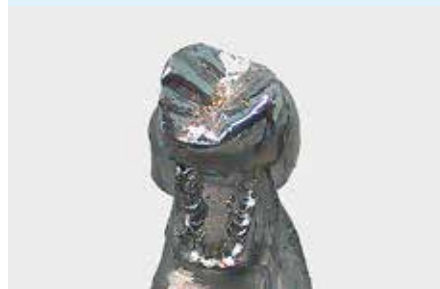
Abb. 2: Lasernaht Titan Beim Verarbeiten von Titan werden durch Laser-Schweißverfahren neue Lotmixe vermieden und dadurch das Unverträglichkeits-Risiko des Patienten gesenkt.
