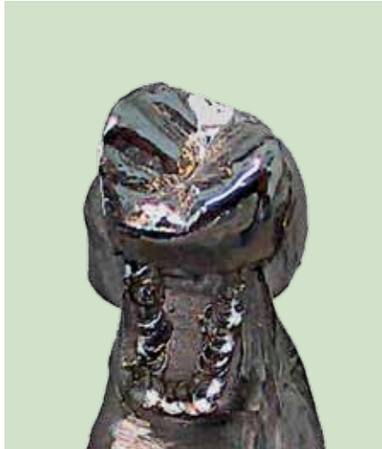
Lasernaht aus Titan
